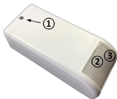
Imagen 1. Cubierta PIR II.
